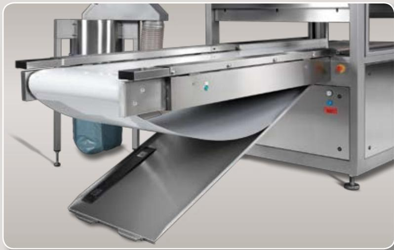
**Auf Knopfdruck entspannt:** Zur kompletten Reinigung wird das Transportband ganz einfach entspannt – komfortabel per Knopfdruck. Der Innenraum der Kammer ist rundum bequem zugänglich, die Seitenfenster lassen sich in eine praktische „Parkposition“ nach oben schieben. Dank hoher Schutzrate ist die Anlage bestens gegen Spritzwasser geschützt und erfüllt strengste Hygienevorschriften.
