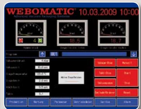
**Unkomplizierte Bedienung:** Der Farb-Touchscreen informiert über den aktuellen Maschinen-/ Programmablauf, sicherheitsrelevante Meldungen werden übergeordnet angezeigt. Durch einfaches Berühren des Bildschirms können alle Parameter sekundenschnell geändert werden.
