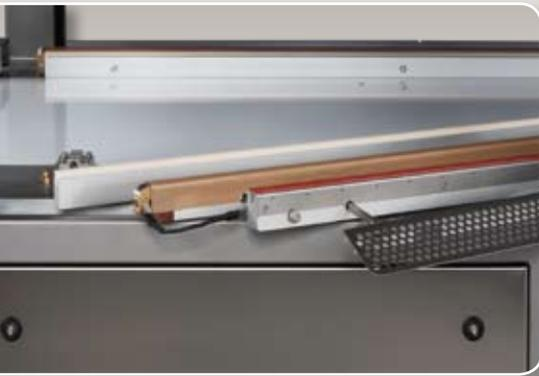
**Siegelsicherheit eingebaut:** Unser intelligentes Siegelssystem TCH-II (Thermo Controlled Heat) garantiert sichere Siegelergebnisse. Die optimale Siegeltemperatur wird schnell und zehntelgradgenau erreicht – und beständig im Idealbereich gehalten. Ein Überhitzen von Siegelleisten und Beutelmateriale ist durch die präzise Temperaturregelung ausgeschlossen, ein zusätzliches Abkühlen der Siegelbalken mit Kühlwasser überflüssig.
