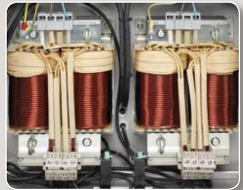
**Kraftvolle Leistung:** Zwei thermisch kontrollierte Siegeltransformatoren liefern passgenau die erforderliche Energie. Die Transformatoren versorgen rechte und linke Siegelseite separat und sind einzeln zu- und abschaltbar. Reaktions-schnell und exakt stellen die kraftvollen Wandler die jeweils benötigte Leistung für das TCH-II-System zur Verfügung.
